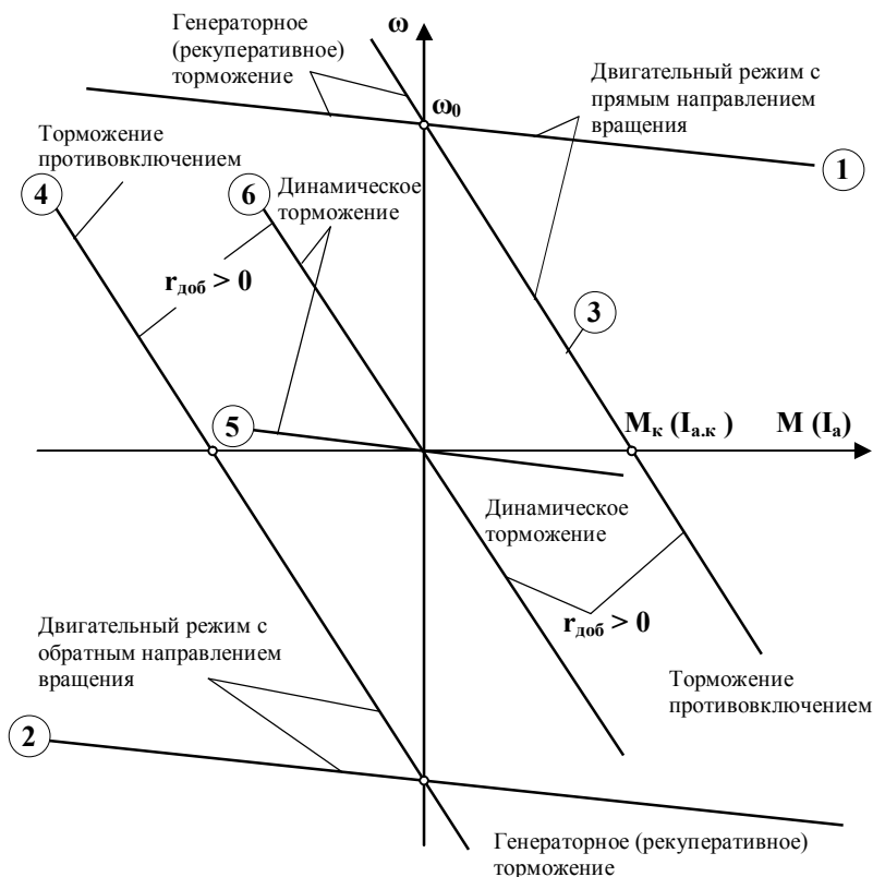
Рисунок 3.2 – Характеристики МПТ НВ в различных режимах работы
